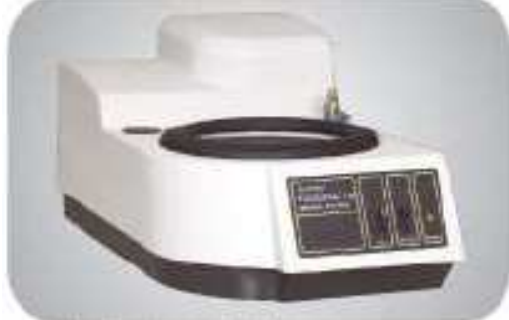
FORCIPOL 1M 1-Teller-Maschine mit 2 fixen Drehzahlen 150 / 300 UPM
