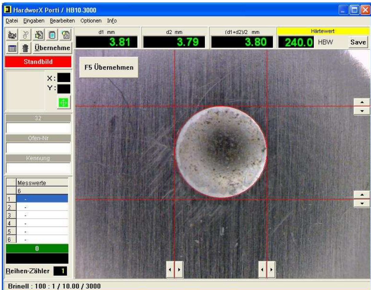
Darstellung: Härteprüfsoftware HardworX Standard: Brinell - Eindruck / Kugelkalotte automatisch vermessen mit VBK - Modul
