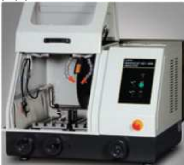
Servocut 301-MM manueller Kapp- und Fahrschnitt
