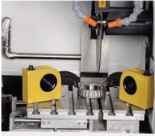
Servocut 301-AA automatischer Kapp- und Fahrschnitt + integrierte X-Achse
