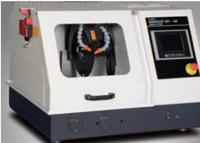
Servocut 301-AA automatischer Kapp- und Fahrschnitt
