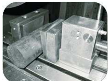
Prismenbacken unten konisch zulaufend
