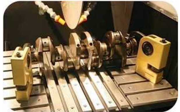
Flexible Spanner für sehr große und schwierige Teile
