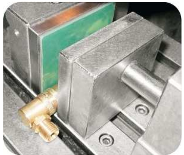
Gummi-Wechselbacken mit Messingschnellkupplung
