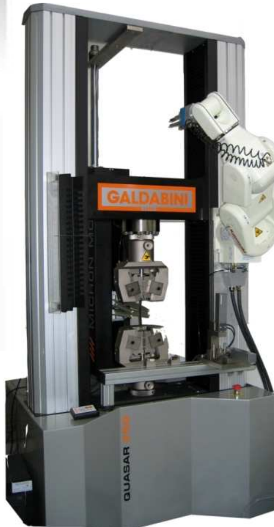
Foto: Quasar 200 mit optionaler Ausstattung: Spannzeug, Dehnungsmesser, Roboter-Handlingssystem Probenmessstation
