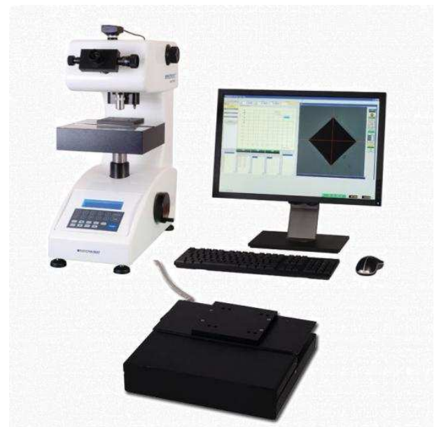
motorischer XY-Kreuztisch: Automatische Positionierung + Erzeugung des Härteprüfeindrucks
