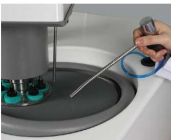
**Ausziehbarer Wasserzulauf für einfache Reinigung**
